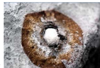
Вверху: серный шар в капсуле. Внизу: капсула с удаленным серным шаром.
